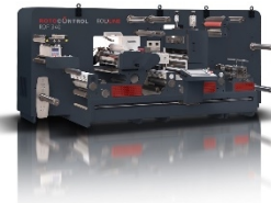
Die ECOLine RDF Verarbeitungs- und Veredelungssystem für digital gedruckte Etiketten
