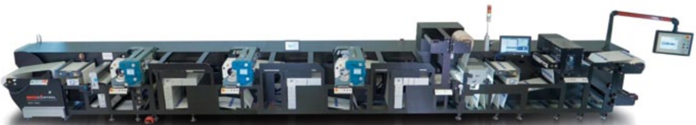
Rotocontrol RCF für die Endbearbeitung von Blanko-Etiketten, mehrlagigen Etiketten und vielem anderen
